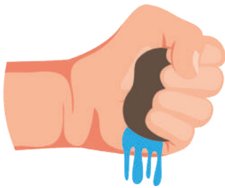
Exceso de humedad
